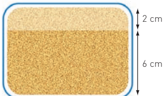
Mousse viscoélastique (2 cm) et haute densité (6 cm) Viscoelastic (2cm) & high density (6cm) foam
